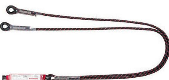
tlumič pádu ABM 2L se dvěmi spojovacími prostředky LB 11 – PA popruh a PA splétané lano Ø 10,5 mm – rozměr tlumiče 160 x 35 x 45 mm – délka systému 1,8 m – možnost připojení volitelné karabiny (Tx – karabina na tlumiči, Lx – karabina na laně)
