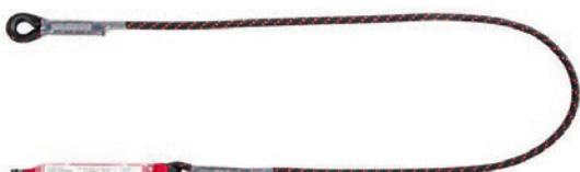
tlumič pádu ABM L se spojovacím prostředkem LB 11 – PA popruh a PA splétané lano Ø 10,5 mm – rozměr tlumiče 160 x 35 x 45 mm – délka systému 1,8 m – možnost připojení volitelné karabiny (Tx – karabina na tlumiči, Lx – karabina na laně)
