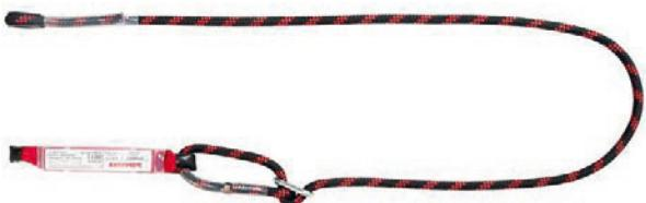
tlumič pádu ABM RL se spojovacím prostředkem LB 10 se seřizovačem délky – PA popruh a PA splétané lano Ø 12 mm – rozměr tlumiče 160 x 35 x 45 mm – délka systému 1,8 m – možnost připojení volitelné karabiny (Tx – karabina na tlumiči, Lx – karabina na laně)-
