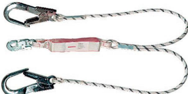
tlumič pádu TPL DOUBLE s dvěma PA lany – PA popruh a PA splétané lano Ø 11 mm, délka systému 1,6 m – na koncích lan jsou připojeny karabinové háky
