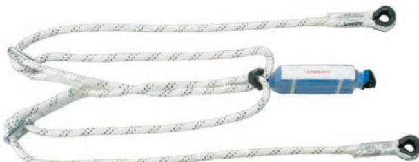
tlumič pádu ABM 2RL se dvěmi spojovacími prostředky LB 10 se seřizovačem délky – PA popruh a PA splétané lano Ø 12 mm – rozměr tlumiče 160 x 35 x 45 mm – délka systému 1,8 m – možnost připojení volitelné karabiny
